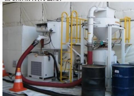
【循環式プラスト機械設備】
