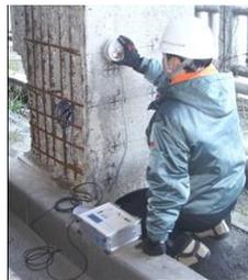
携帯型腐食診断機による効果確認試験
