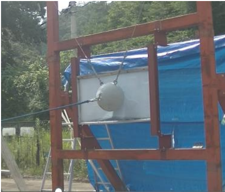
SPシート工法を施工した透光板
